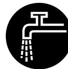
Trennschleifscheibe nur mit Wasser verwenden.
